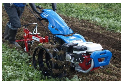
شکل ۳- تراکتور دو چرخ در حال شخم با گاواهن تک‌خیش (منصوری‌راد، ۱۳۸۹)
