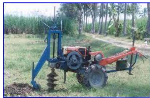
شکل ۵- تراکتور دو چرخ در حال کندن گودال (منصوری‌راد، ۱۳۸۹)
